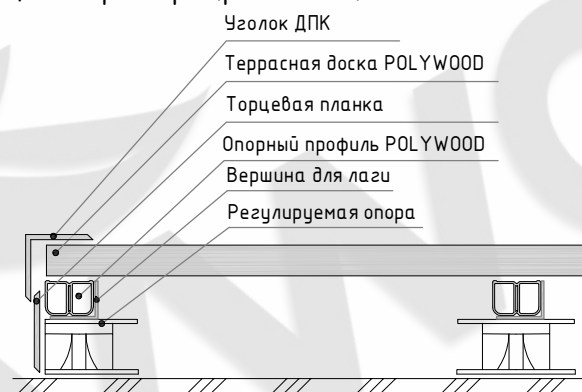
Рис.11 Монтаж с уголком из дпк
